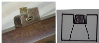
図⑪、図⑫真鍮の板などを折り曲げて挟むまたは接着剤でつける方法、筋を大きく削る方法。
