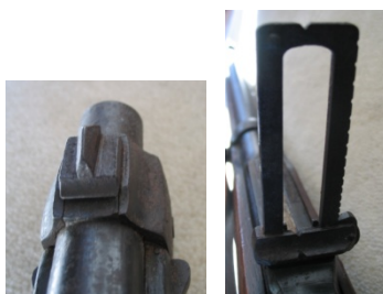
図⑬、図⑭二十二年式（1888）8mm 小銃の照準器 照門はラダー型であり、前に倒して状態で 100m 起こして一番下が 200m、右のノブを押しながら 100m ずつ上げていく。銃口が持ち上がることで遠距離を狙う。照星の形状は火縄銃のものに近い形状、
